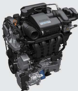
1,5 literes Atkinson-ciklus DOHC i-VTEC motor
