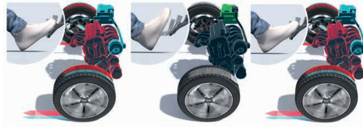
A Hybrid 48V iMT rendszer működése szabadonfutás ("vitorlázó funkció") közben.
